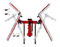
Inclinación hidráulica independiente de barras vertical y horizontal para laderas
