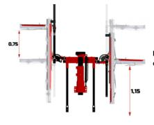
Elevación hidráulica de barra horizontal para viña en vaso y espalderas
