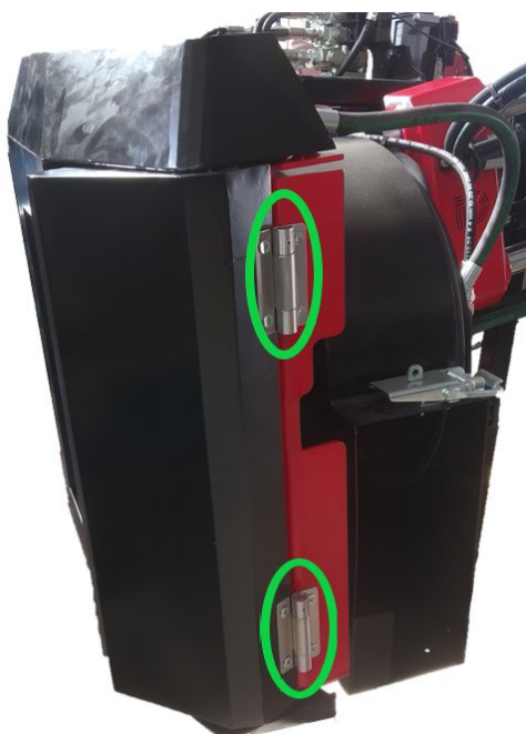
Posición bisagras unión cuerpo-palpador
