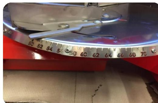
**ATENCIÓN:** Antes de plantear las paletas distribuidoras coloque la máquina con la tolva llena directamente en el campo a fertilizar.
