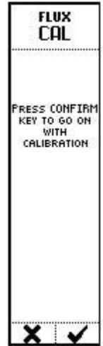
Después de la confirmación de procedimiento de calibración, una pantalla muestra el nuevo valor del factor de flujo obtenida a través de calibración.
