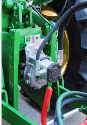
Es muy importante evitar que el acoplamiento del Grupo Bomba multiplicador al tractor quede rígido, ya que debe disponer de un ligero movimiento o flotación que permita absorber los posibles movimientos del eje de la TDF sobre el conjunto.
