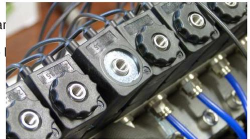
Desmonte la bobina y localice la regleta de bornes donde se unen los cables de la electroválvula; utilice un destornillador para liberar los cables de la misma regleta de bornes.
