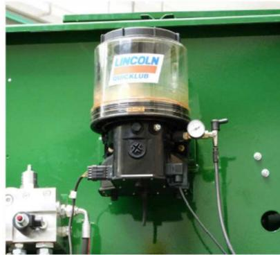
El tiempo de lubricación configurado puede ser forzado mediante el control del TERA situado en la cabina, manteniendo presionado el botón "FS". Independientemente de los tiempos configurados en la bomba centralizada, cuando se presiona este botón la bomba envía el lubricante a los puntos de lubricación conectados a ella a través de uno o más distribuidores.
