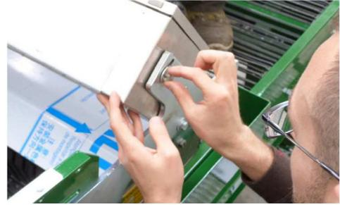
Ajuste la posición de la unidad neumática mediante las dos ranuras (D) del soporte.
