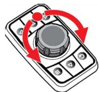
Cambiar los datos seleccionados a través de la rotación del controller. Girar hacia la derecha para aumentar el valor del dato y hacia la izquierda para reducirlo.
