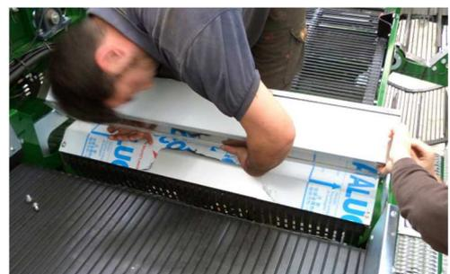
Coloque la parte óptica entre los dos soportes y fíjela con los tornillos suministrados.
