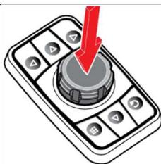
Presionar el controller para confirmar el valor. Mantener presionado durante aprox. tres segundos para confirmar el dato y salir de la selección.
