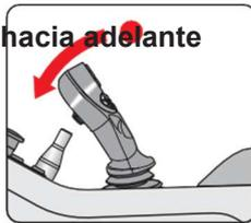
Hace avanzar la máquina, cuya velocidad viene determinada por el acelerador.
