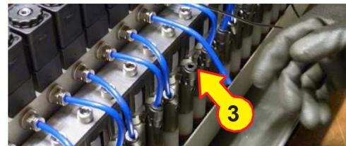
Desenrosque la paleta del cilindro y sustituya el componente roto a través de la conexión (A).
