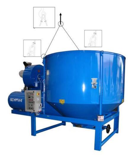
Fig. 04.02 - Elevación de la máquina
