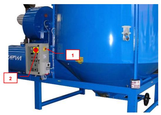
Fig. 05.04 - Disposición del mando de paro de emergencia y del dispositivo de interrupción de la energía eléctrica en la máquina
