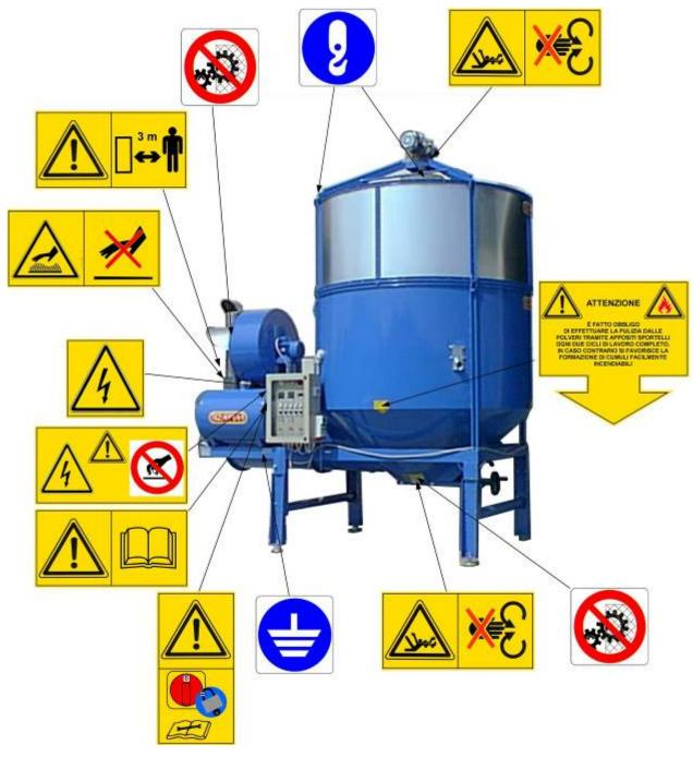
Fig. 03.03 - Ubicación de las pegatinas en la máquina
