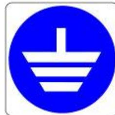
Indica el punto para la puesta a tierra del secadero que se debe realizar antes de la puesta en funcionamiento de la máquina.
