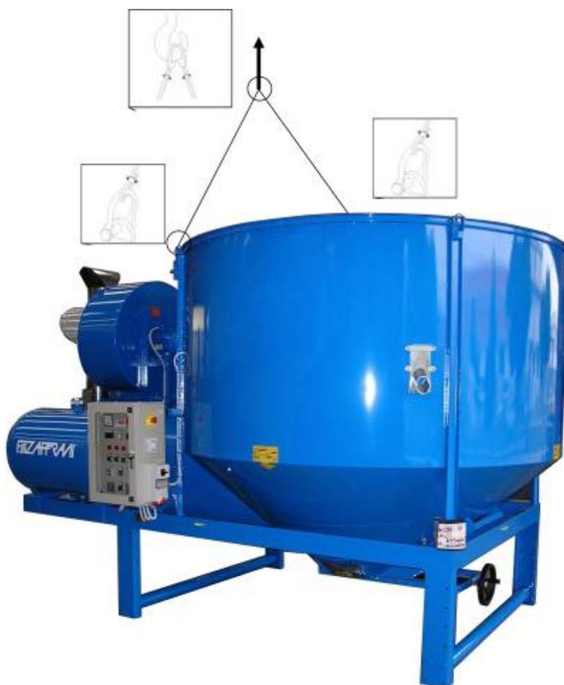
Fig. 04.02 - Elevación de la máquina
