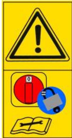
Antes de iniciar cualquier tipo de intervención lea atentamente el manual, pare la máquina y bloquee el interruptor seccionador con un candado.
