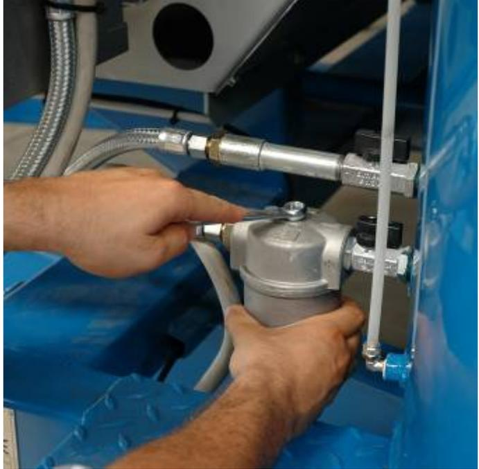
Fig. 06.02 – Sustitución del filtro de gasóleo
