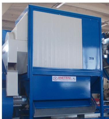
Vaglio rotante con sistema intercambiabile per pulizia vari frutti eliminazione corpi estranei più pesanti e più grandi Rotating screen with interchangeable system for cleaning various fruits elimination of heavier and larger foreign bodies
