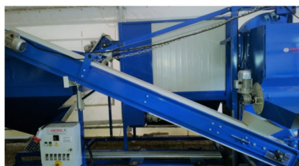
Uscita prodotto pulito per scarico ad altezza di circa 3,60 con inserimento di nastro elevatore estraibile /richiudibile Clean product outlet for unloading at a height of about 3.60 with insertion of a removable / reclosable elevator belt for movement
