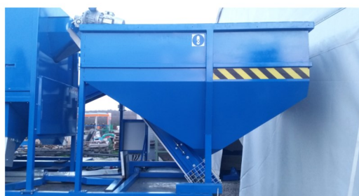
Sistema di carico con tramoggia di contenimento prodotto sporco con nastro elevatore di carico Loading system with hopper for containing dirty product with loading elevator belt
