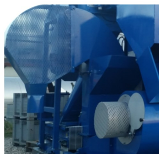
Ventilazione per eliminazione impurità più leggere Ventilation for the elimination of lighter impurities
