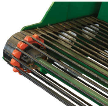
> Piñones de goma para disminuir el desgaste de las cintas.
