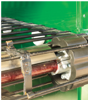
> Piñones de goma para disminuir el desgaste de las cintas.
