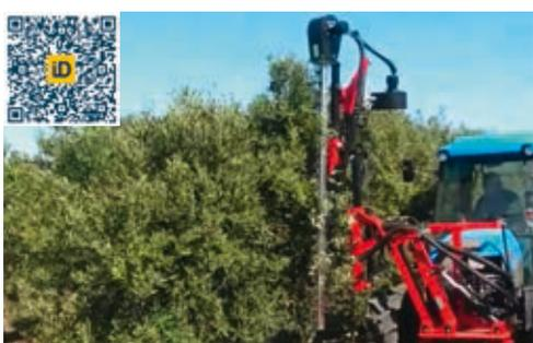
**Pre-podadora de cuchillas tipo "L"** para poda simultánea de lateral y copas de frutales, olivos y almendros de cultivo super-intensivo. Multitud de configuraciones según la necesidad.
