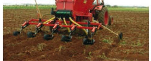
**Remolque aplicador de fertilizante** de 2.5 o 5 m<sup>3</sup>. Apto para la distribución superficial o localizado bajo tierra de abonos granulados y pellets.
