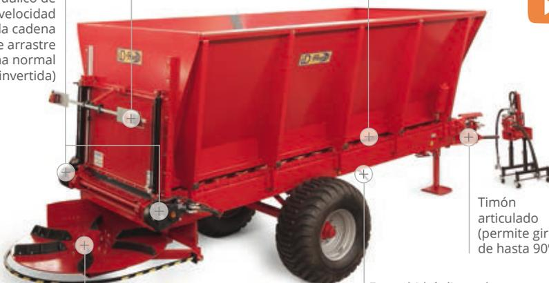
Disco esparcidor sin eje con buje reforzado de Ø1500mm
