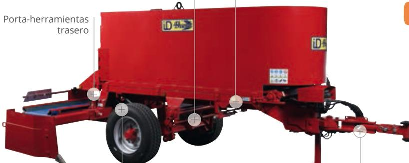
Regulación hidráulica de profundidad de trabajo y altura de transporte
