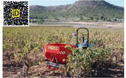
**Abonadora suspendida de precisión** de 600 L hasta 1000 L. Apta para la distribución superficial o localizado bajo tierra de abonos granulados, en polvo y pellets.
