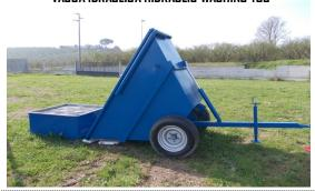
Questo modello di vasca è dotata di timone , pistone idraulico per il ribaltamento e ruote .Qui i residui e i sassi per via del loro peso specifico si depositano sul fondo. Una volta eseguiti i cicli di lavaggio necessita di essere svuotata quando oiena.
