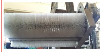
Accessorio progettato per consentire la pulizia del prodotto durante il passaggio lungo il flusso dell'acqua dovuta allo sfregamento fra due corpi spazzole, progettati in modo tale da favorire l'uscita
