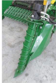
> Sinfín divisor para separar las guías cuando las hileras están cruzadas.
